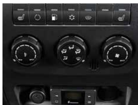
Блок управления системой кондиционирования и отопления
