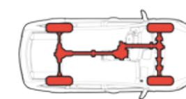
Включение пониженной передачи в раздаточной коробке с передаточным отношением 2,542 : 1 идеально подходит для самого тяжелого бездорожья
