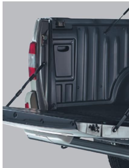
Вкладыш в грузовой отсек
