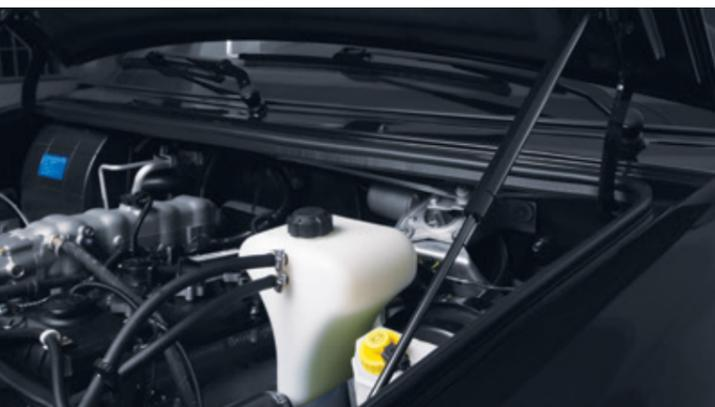
Пневмоупоры капота обеспечивают удобный доступ к моторному отсеку
