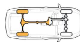
Крутящий момент двигателя передается только на задние колеса, позволяя экономить топливо при езде в нормальных условиях
