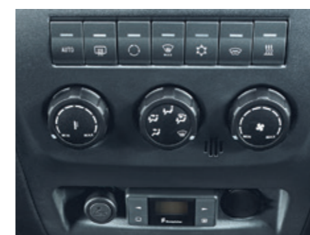
Блок управления системой кондиционирования и отопления
