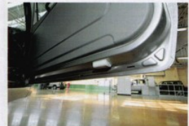
С увеличенным «сухрем» задней двери уплотнитель перестанет обминаться и пропускать в салон пыль и грязь
