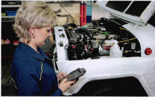
Во время промежуточного контроля качества сборки на конвейере контролеры отправляют всю информацию о замечаниях на заводской сервер, а мастера могут ознакомиться с состоянием дел в любой момент — мониторы стоят прямо в сборочном цехе
