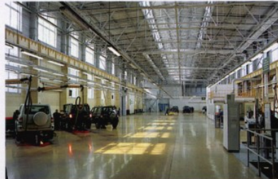
Этот участок выходного контроля появился благодаря началу производства Патриота. Справа видны стены проверки фар, тормозных усилий, углов установки колес и дождевальная камера
