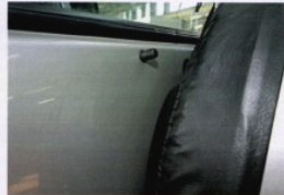
Форсунка омывателя заднего стекла «перехлестала» в более спокойное место за запасным колесом и теперь закреплена надежнее
