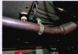
Сиффон и крошечные выпускной системы стали крепче. Во время ресурсного теста первый раз мы заварили крошечный сиффон через 4300 км, а сиффон заменили через 17500 км
