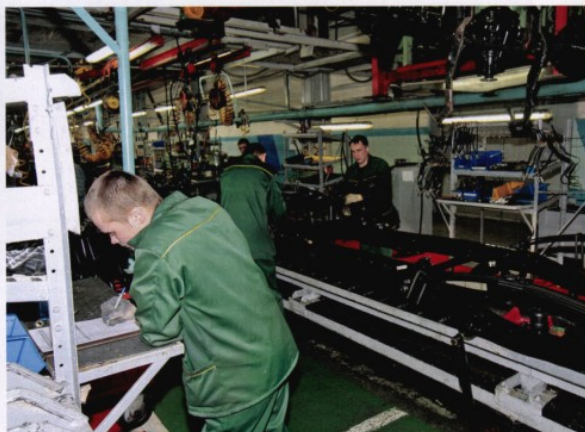
После завершения сборочной операции рабочий меняет инструмент на ручку и расписывается в сопровождающей каждую машину карте сборки
