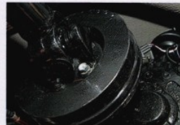
Будь кардан на нашем «ресурсном» Патриоте закреплен такими, более прочными болтами, он не отвалился бы через 27500 км
