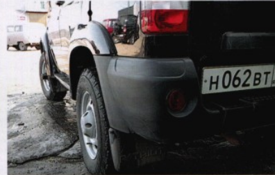
После рестайлинга у Патриота исчезнут безобразные щели между бампером и задним крылом — наружные секции составного бампера (на фото — их предварительный вариант) будут крепиться не к раме, а к кузову
