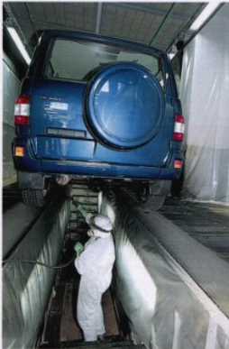
Антикоррозийная мастика Nova-гриф наносится вручную при помощи шведского оборудования ASSALUP. Новый участок расположился на самом выходе из сборочного цеха и обошелся заводу в девять миллионов рублей
