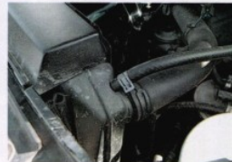
Уже заканчиваются испытания машин с пружинными хомутами Mobeve на шлангах системы охлаждения
