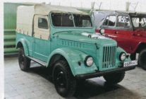
Выпуск внедорожников ГАЗ-69 и 69А в Ульяновске начался в 1954 году. С небольшими изменениями машины производились на конвейере 19 лет — всего выпущено 597 тысяч автомобилей с нижневальным мотором от Лодовы (2,1 л, 52 л.с.) и трехступенчатой коробкой передач
