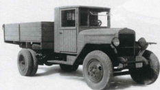
Первая продукция завода — грузовик ЗИС-5 и его упрощенная версия ЗИС-5В с деревянной кабиной (на фото). С мая 1942 по февраль 1944 года в Ульяновске сделали более 10 тысяч тректоров
