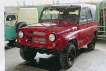
Легендарный УАЗ-469 (2,4 л, 75 л.с.) начали выпускать в декабре 1971 года — на долгие годы этот автомобиль стал основой производственной программы завода. Машины не продавали частникам вплоть до модернизации 1985 года — для этого в десерт наконец-то появились запатрированные заявки
