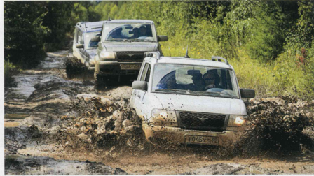
С хода дизельный Патриот в состоянии преодолеть практически любой грязевый участок. Но там, где требуется аккуратное маневрирование, тут же дают себя знать недостатки низкие сцепные свойства шин Maxxis Buckshot Mudder
